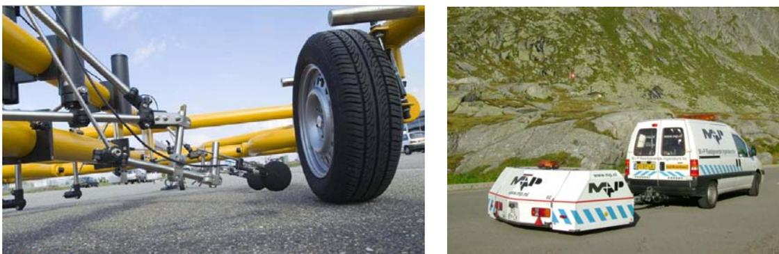
Fig.3 - Trailer per la misura in alto rendimento delle prestazioni acustiche delle pavimentazioni stradali con il metodo CPX.
