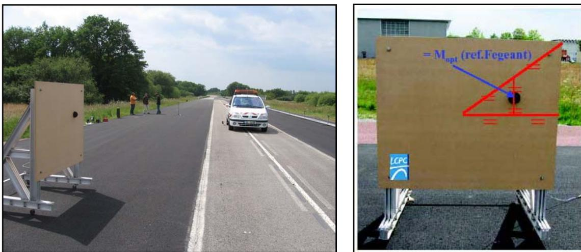
Fig.6 - Applicazione del metodo SPB con Backing Board..
