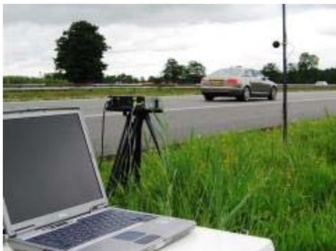
Fig.1 - Set-up sperimentale per la misura in situ della rumorosità delle pavimentazioni con il metodo SPB.
