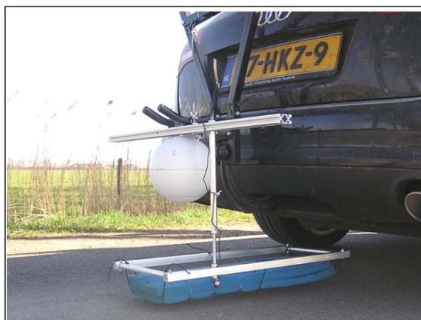
Fig.7 - Sistema impiegato per la misura dinamica del coefficiente di assorbimento delle pavimentazioni mediante sonda combinata PU.
