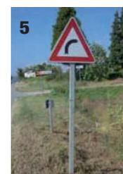
**5. "Il segnale curva pericolosa - recita il "Vademecum" - deve essere usato per segnalare una curva pericolosa, per caratteristiche planimetriche o per insufficiente visibilità. In realtà il suo maggior impiego è per segnalare una qualsivoglia curva, fornendo all'utente un messaggio fuorviante"**
