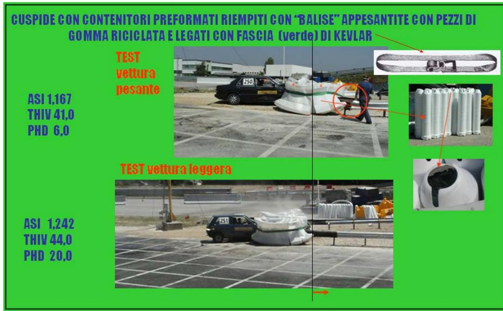
**Figura 12 – La prima soluzione funzionante con i contenitori collegati con fascia di tessuto resistente.**
