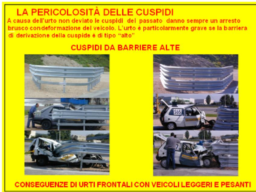
Figura 3 – Crash test frontali con vetture pesanti e leggere
