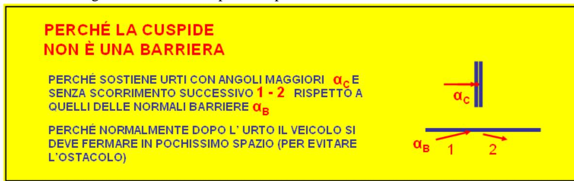
Quest'ultima diversità intrinseca è divenuta sempre più pericolosa quanto più le barriere hanno incrementato la loro resistenza passando dalle semplici bi-onde alle triple onde, a volte anche raddoppiate a livelli diversi.
