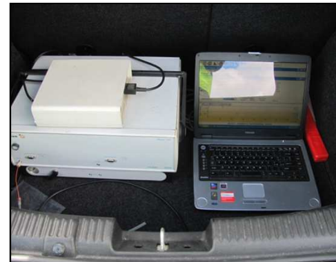
Gas-cromatografo portatile utilizzato per il monitoraggio dei sondaggi
