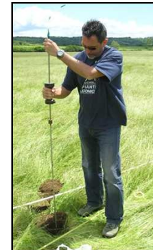
Prelievo di campioni di gas nei suoli
