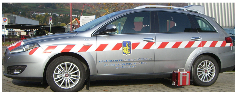
Figura n. 3 – Il veicolo DELPHI (DELineation PHotometric Instrument) del CSS ANAS [8]
