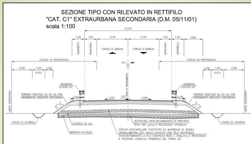
Indipendentemente dal tipo di materiale utilizzato per la formazione dei rilevati, nel progetto A12 – Tor de' Cenci, è stato sempre previsto l'inserimento di uno spessore di 1,5 m di materiale alleggerito al di sotto del piano di posa, al fine di conseguire una parziale compensazione dei carichi.
