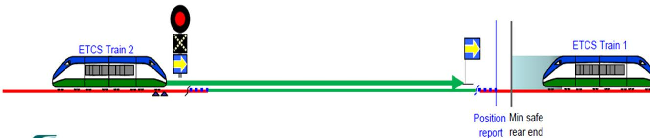
Quando il treno ETCS 2 è in prossimità del segnale luminoso, l'interlocking «comanda l'accensione della X» così da consentire l'avanzamento al treno fino al successivo segnale di sottosezione ETCS (sezione liberata dal precedente treno ETCS 1)
