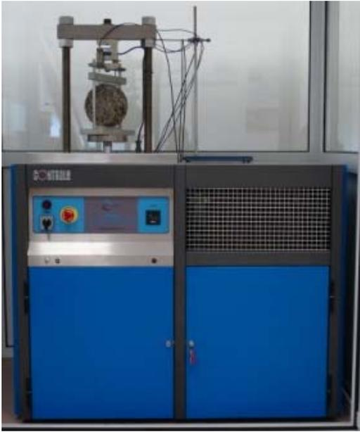
Figura 1. Pressa dinamica a basso costo per test a fatica
