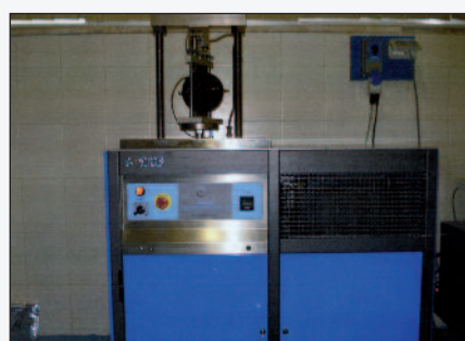
Figura 11 - La pressa dinamica per test di fatica (Cesano)
