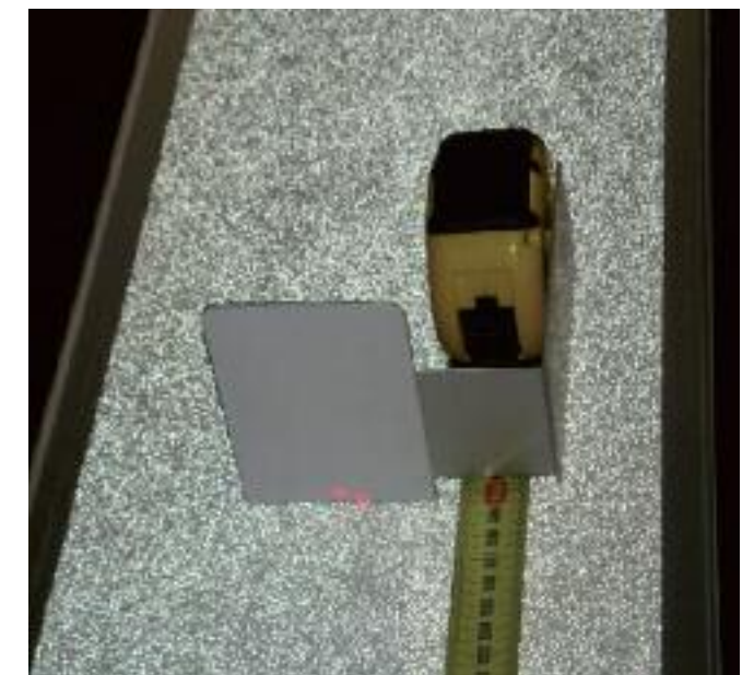
Figura 4 - Centrazione della testa di misura durante la fase di taratura
