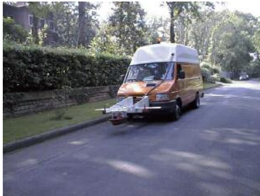
Figura 2 - Mezzo ad alto rendimento per la misura dell'indicatore individuale spessore degli strati costituenti la pavimentazione
