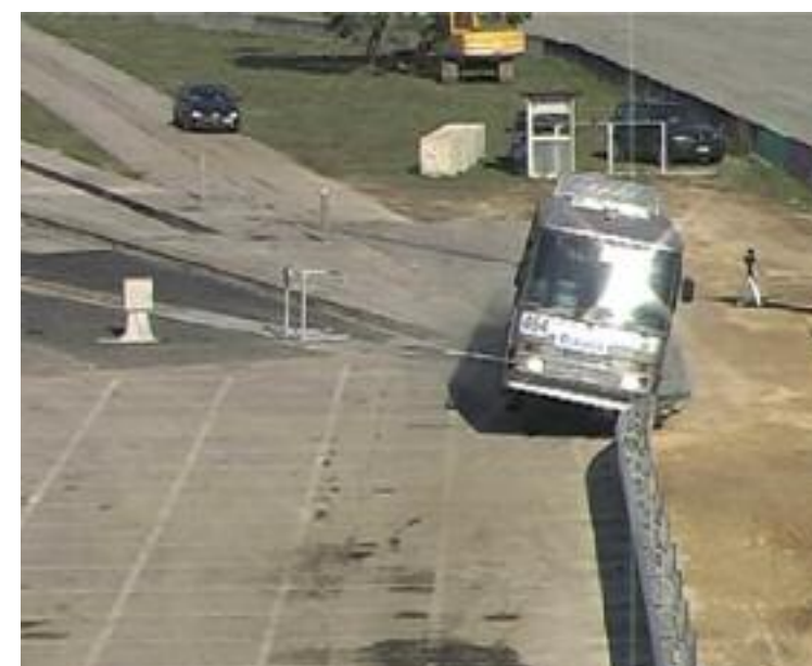
Figura 4 - Urto di un autobus di linea lanciato a 70 Km/h con inclinazione di 20°
