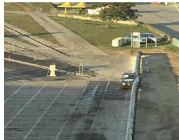
Figura 3 - Urto dell'autovettura lanciata a 100 Km/h con inclinazione di 20°: il manichino strumentato ha dato un risultato per HIC (Head Injury Criteria) pari a 44, il più basso della categoria
