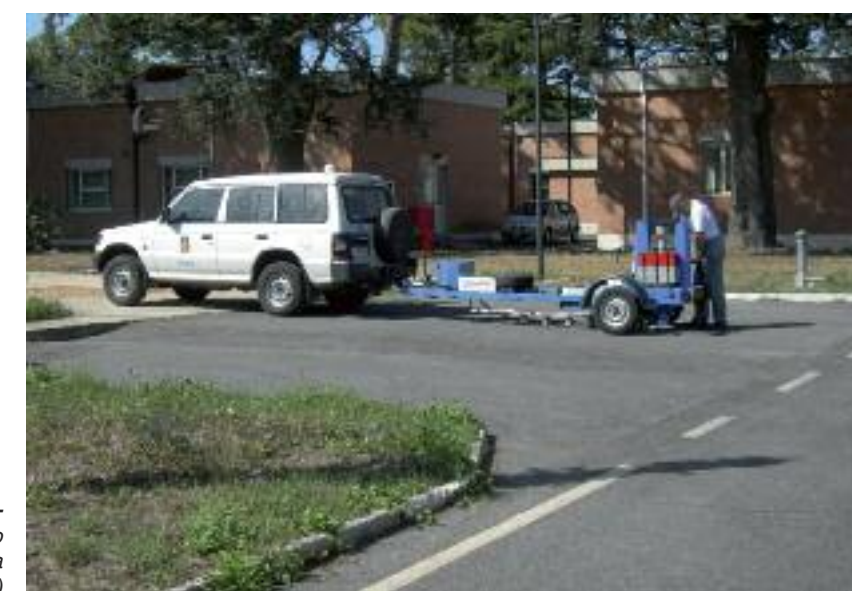
Figura 1 - Mezzo ad alto rendimento (Falling Weight Deflectometer) per la misura dell'indicatore individuale IS (Indice Strutturale)
