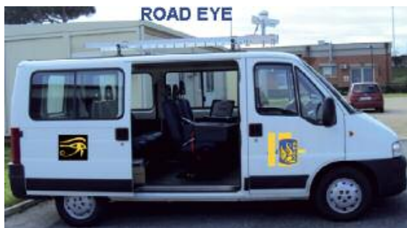
Figura 4 - Mezzo ad alto rendimento (Road Eye) per il rilievo dei difetti superficiali della pavimentazione, la loro catalogazione e collegamento agli interventi di manutenzione.
