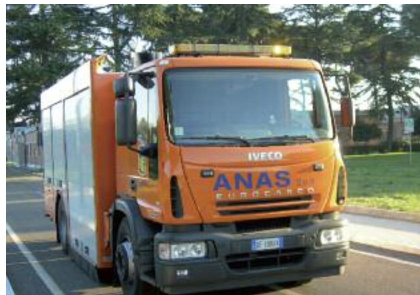
Figura 3 - Mezzo ad alto rendimento (Ermes) per la misura degli indicatori individuale CAT (coefficiente di aderenza trasversale), HS (altezza di macrotestitura) ed IRI (International Roughness Index)
